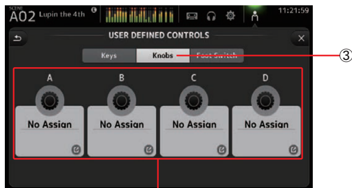
④ Кнопки настройки
